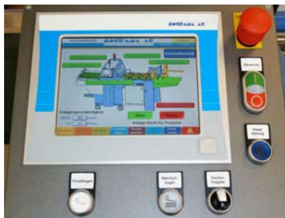
Ein zentrales Steuersystem mit Touchscreen kontrolliert die gesamte Maschine.
