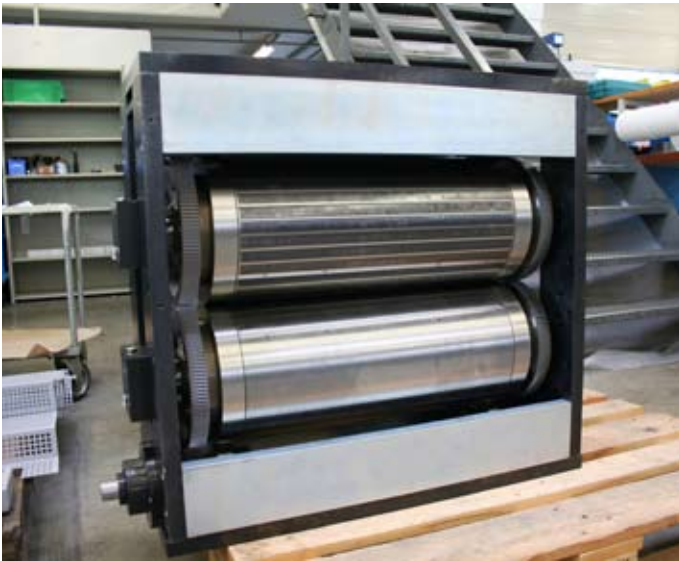
Die Beiden Zylinder, auf denen die Stanzbleche per Magnet befestigt werden.
