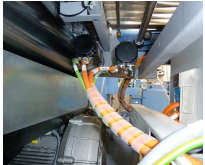
Die Servomotoren positionieren die Papierbögen bei einer Geschwindigkeit von bis zu 165m/min auf den Zehntelmillimeter genau.
